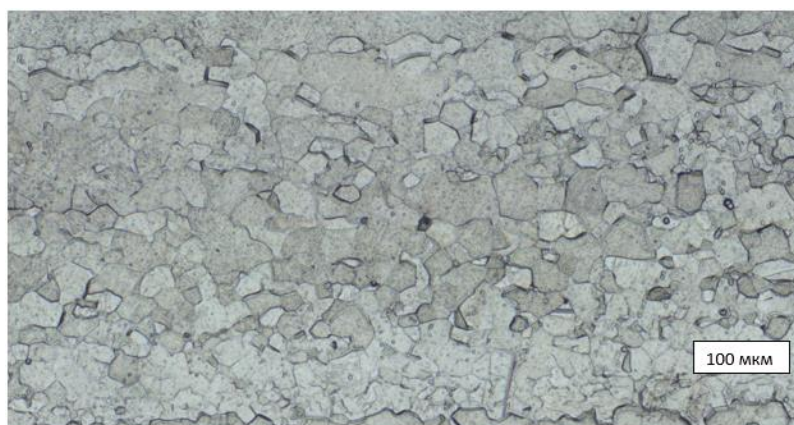
Рис. 2. Микроструктура сечения листа партии №209320 вдоль направления финишной прокатки
